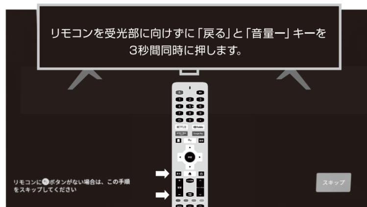
初回セットアップの時に画面に表示される手順に従って、リモコンとペアリングを行います。リモコン受光部に向けずに「戻る」ボタンと「音量-」ボタンを同時に3秒間押します。
